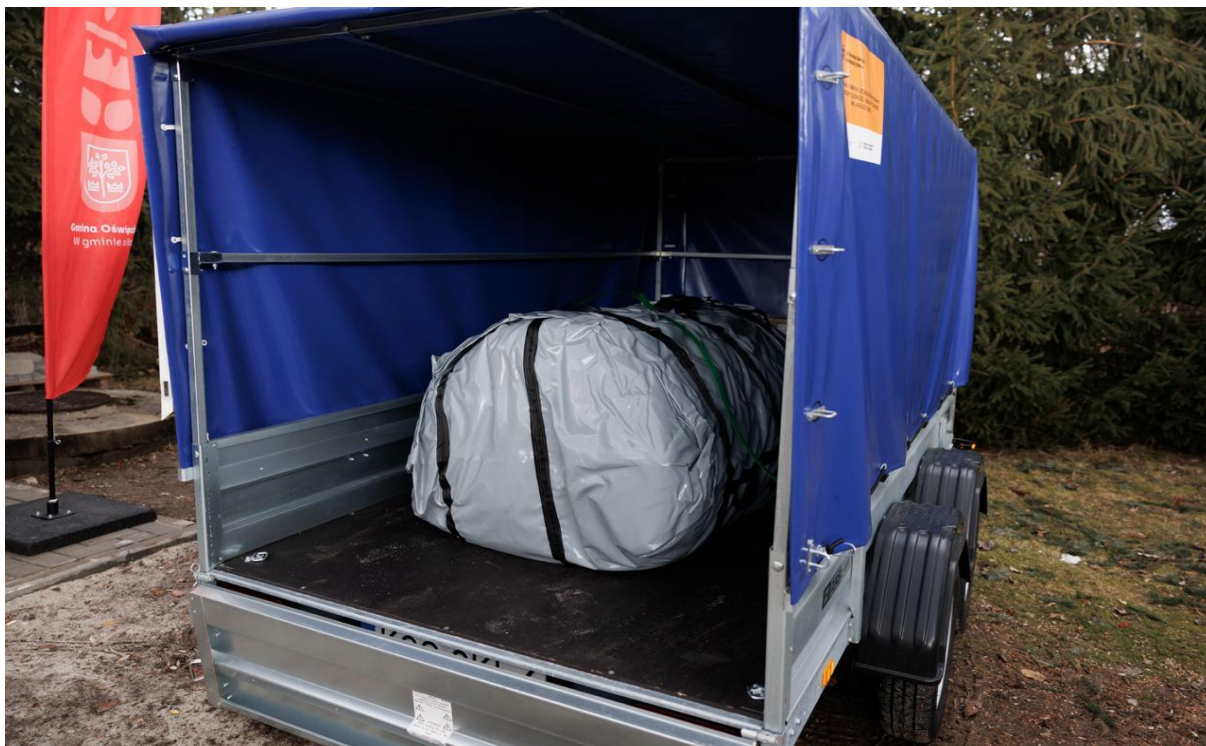
Fot. XVI.2. Przyczepa lekka z pneumatycznym namiotem ratowniczym
